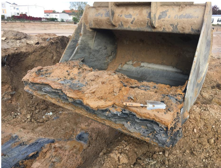
Abb. 4-3 Sensorisch auffällig in Aussehen und Geruch waren die grünlich-grau bis schwarz verfärbten Feinsandlagen, welche sich vor und neben dem Erdtank , etwa auf dessen Sohlniveau, befanden.
